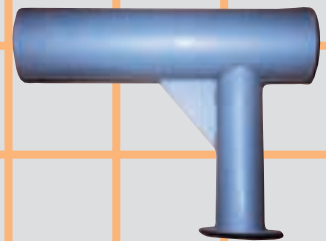
Geluidemper op uitlaat voor turbo in zuigopstelling.
