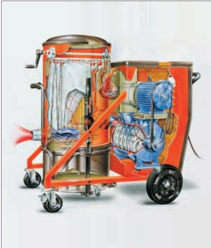
Turboventilator toegepast als zuigunit in een Kiekens industriestofzuiger.
