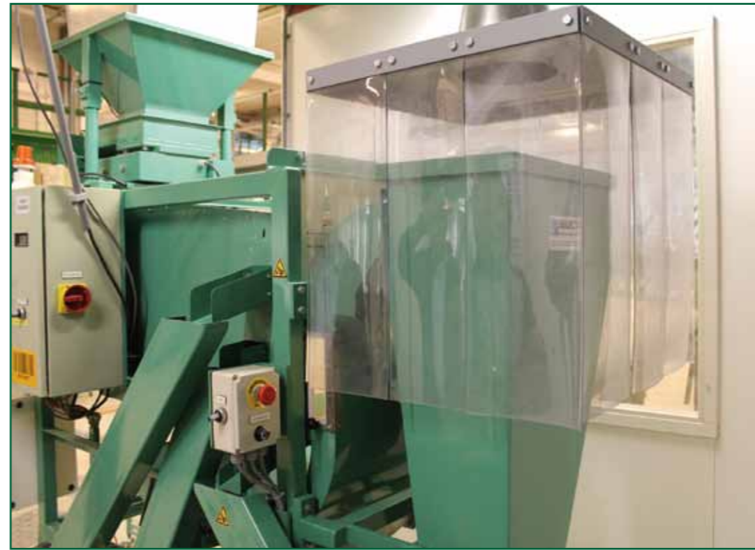
Door ontstopping bij de bron aan te pakken, is bijvoorbeeld slechts een omkasting van een beperkt deel van een bewerkingsmachine nodig. Dat scheelt benodigde afzuigcapaciteit en scheelt ook energiegebruik
