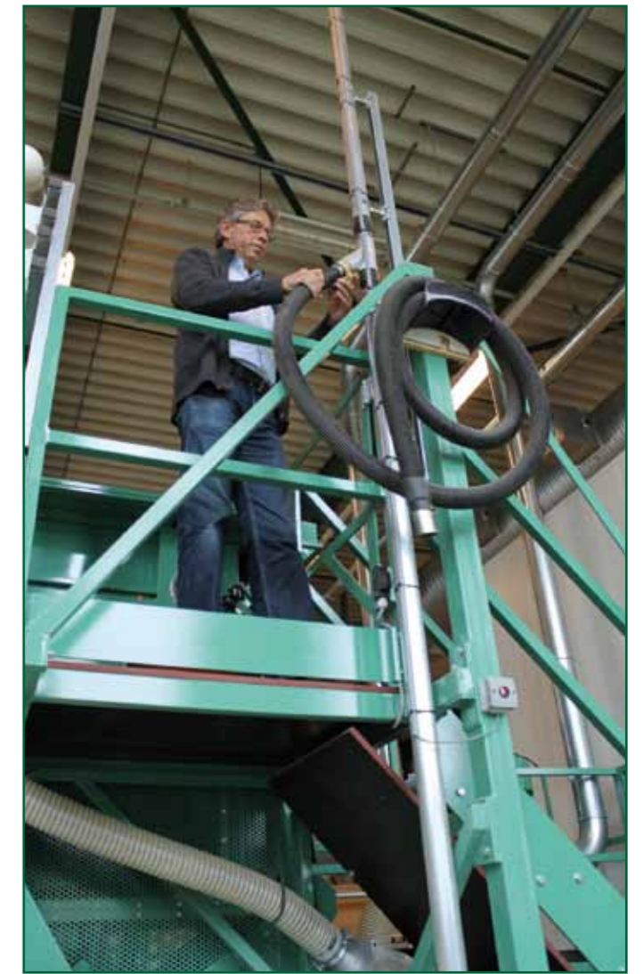
Een centrale stofzuiginstallatie werkt beter dan een industriële stofzuiger naast elke bewerkingsmachine. De installatie is altijd beschikbaar en voert meteen af. Geen ergernis meer door kapotte stofzuigers of slangen of kabels die kras over de werkvloer liggen
